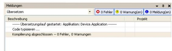
Falls doch ein Fehler auftreten sollte, wird dieser in den Meldungen angezeigt. Durch einen Doppelklick auf die Fehlermeldung springt CODESYS V3 automatisch zum Ort des Fehlers. So lassen sich Fehler effektiv und einfach beheben.
