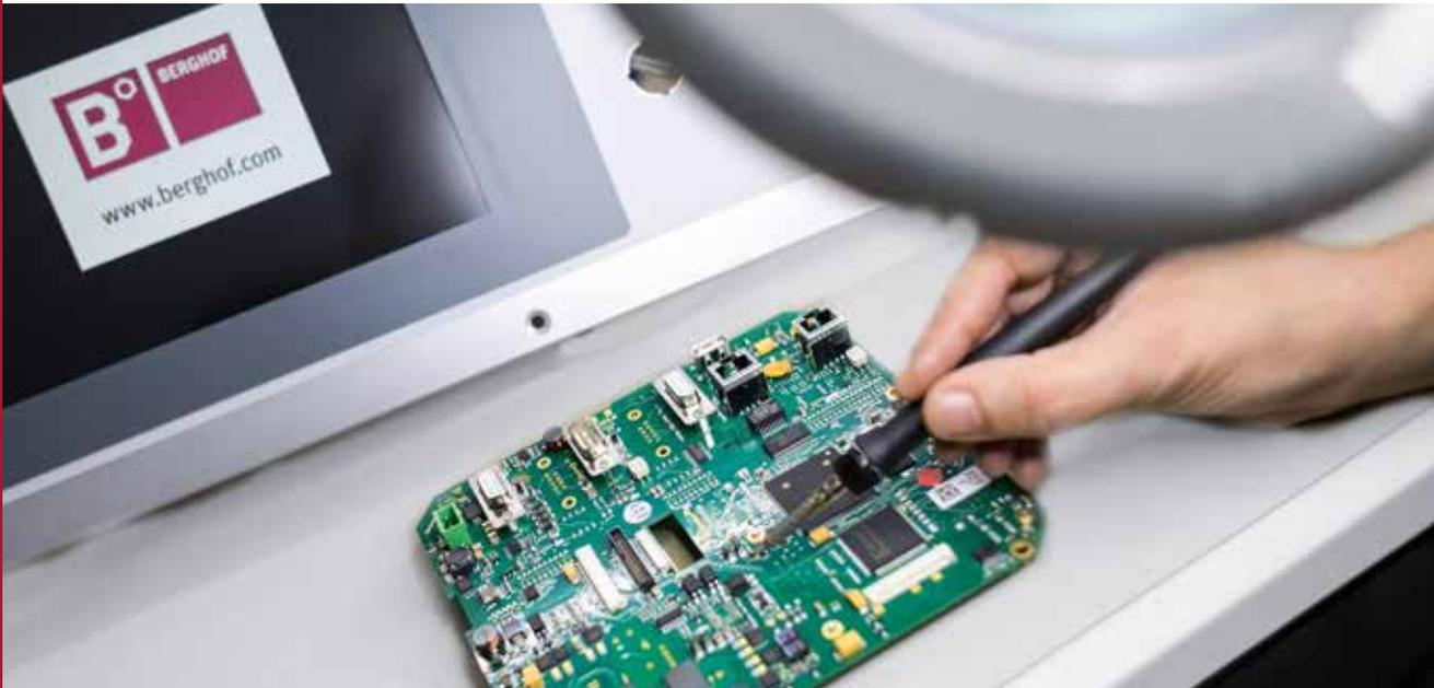
Wissen und Erfahrung sind bei der Instandsetzung von SPS-Baugruppen, Bedienpanels oder Industrie-PCs vonnöten. Sollte eine Baugruppe ausgefallen sein, so ist nicht immer ein Komplettaustausch erforderlich. Vor allem hochwertige Produkte sollten durch Experten auf Wiederherstellung geprüft werden.
