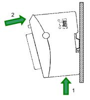
Fig.: 3 Installing the B-Nimis MC-Pi & BC-Pi
